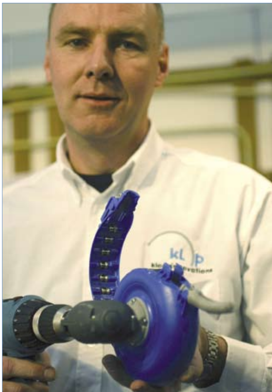
AfB. 2: 'Uitvinder' Henk Klop: "Iedereen onderschat de weerstand van de veer in de buis. Bij het invoeren schuift de totale lengte van de veer langs de wand van de pvc-buis en stoot daarbij tegen bochtjes en sokken aan waardoor er forse wrijvingsweerstand ontstaat."
